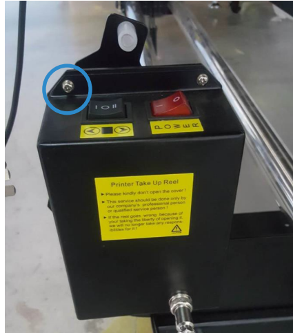
Abrir la caja de control, ajustar los engranajes para cambiar la distancia de recorrido
