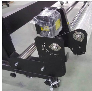
Fijar el sistema de tensado el rodillo de apoyo hacia arriba
